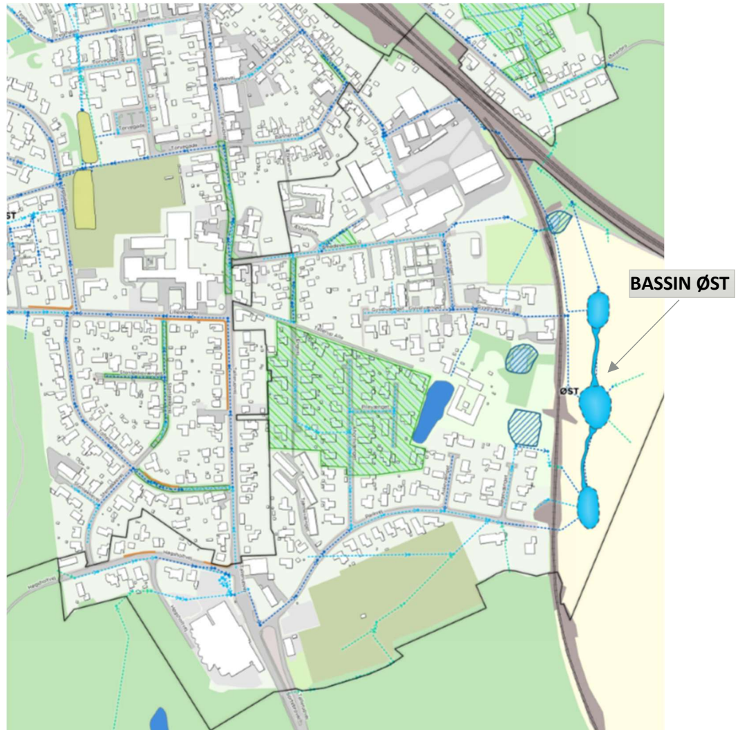
Figur 1.1 : Oversigtskort med angivelse af planlagt 3-delt bassin (Bassin Øst) i den østlige del af Tommerup Stationsby, opland til bassinet (markeret med sort linje) samt eksisterende (lyseblå) og planlagte (blå) afskærende regnvandsledninger til bassinet. Tre eksisterende bassiner nedlægges (blå skravering). Kortudsnit er fra "Regnvandsplan for Tommerup Stationsby". NB Selve Bassin Øst er allerede planlagt i den eksisterende godkendte spildevandsplan.
